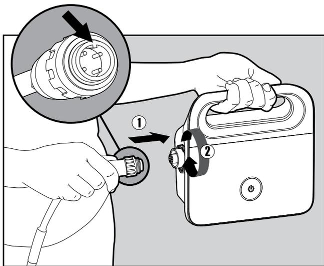
**5.1.3** Collegare il cavo flottante all'alimentatore inserendolo con la tacca sul connettore (1) allineata con la scanalatura nella presa sull'alimentatore, e girare in senso orario (2).
